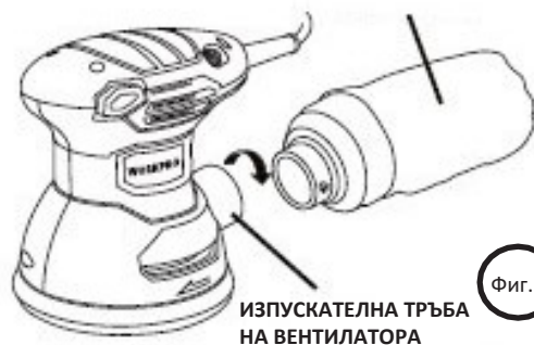
МОНТАЖ НА ТОРБИЧКА ЗА ПРАХ
