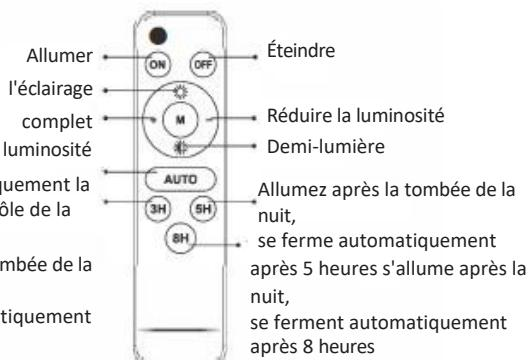
S'allume automatiquement la nuit grâce au contrôle de la lumière.
