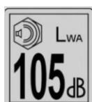
Nivelul de putere acustică garantat (testat în conformitate cu Directiva 2000/14/CE, astfel cum a fost modificată prin 2005/88/CE).
