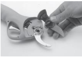
4. Dévissez la goupille et retirez la lame mobile
