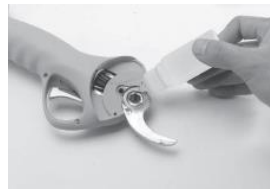
6. Lors du remplacement des lames, il faut ajouter de l'huile de graissage entre les deux.
