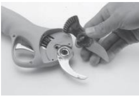
4. Odvijte zatič in odstranite premikajoče se rezilo
