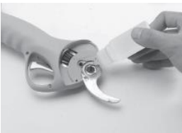
6. При смяна на остриетата, между тях трябва да се добави смазочно масло.
