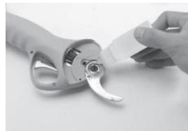
6. Pri zamenjavi rezil, vmes je treba dodati mazalno olje.
