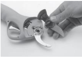
4. Deșurubați știftul și scoateți lama în mișcare.
