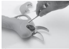
2. Îndepărtați șuruburile de la piulița de fixare a piuliței lamei (acest pas este esențial).
