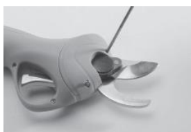
1. Csavarja ki a csavarokat egy csavarhúzóval, és nyissa ki a fedelet.
