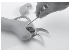
2. Távolítsa el a csavarokat a pengeanyát rögzítő csatot (ez a lépés kritikus).
